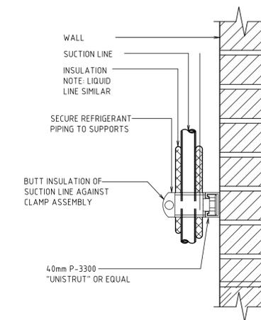
**REFRIGERANT PIPE SUPPORT AT WALL**
